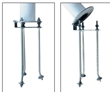
Kipphalterungen aus Stahl, feuerverzinkt für GfK-Masten , Schraubflansch in Rundform, Sicherheitskippscharnier, Ankerkorb
